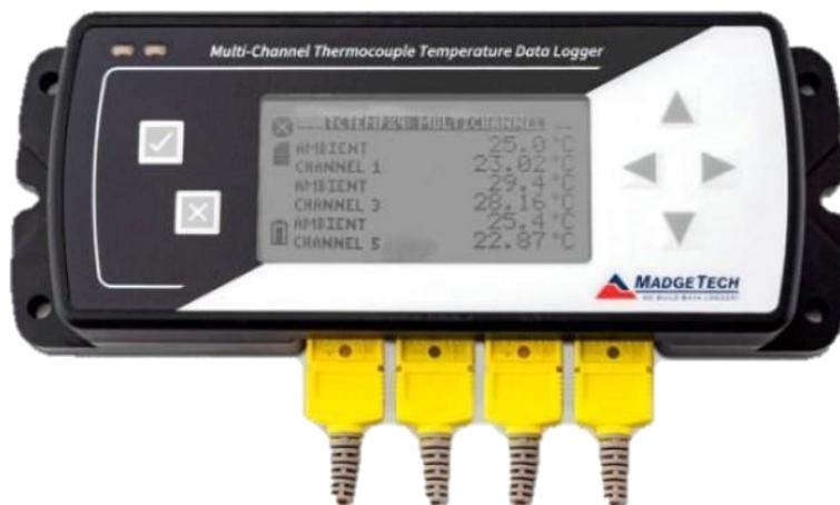
O TCTempX4LCD e o TCTempX8LCD são registradores de dados de termopares de quatro e oito canais com uma tela LCD. O dispositivo apresenta na tela estatísticas com mínimas, máximas e médias, assim como uma tela configurável pelo usuário que permite que qualquer combinação de canais seja exibida. O dispositivo aceita J, K, T, E, R, S, B e N tipo termopares.
